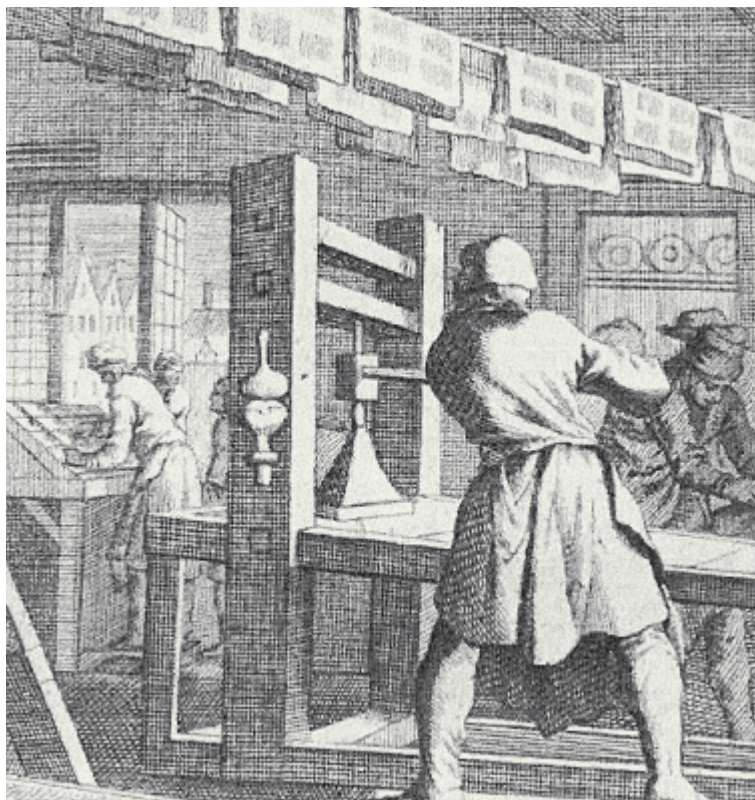
6.4. Pohled do knihtiskařské dílny. Po otištění byly archy sušeny pověšením na tyč anebo provaz. 60
