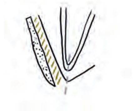
713. Předsádka tvořená listem s křídélkem obtočeným kolem první (poslední) složky. Šití vedeno přes střed složky. První list vylepen na předešlý (sign. VI.D.β.4). 225
