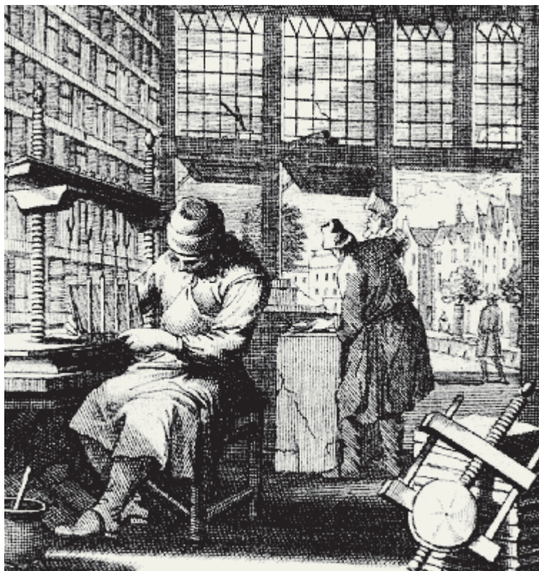
6.10. Pohled do knihařské dílny na konci 17. století. V pozadí proces rovnání, vepředu našívání knižního bloku na rámovém stávku (taky vazačka či šibenice). V pravém dolním rohu knihařský hoblík s kulatým nožem, sloužící k ořezávání bloků. 108
