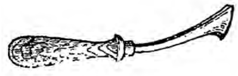
Obr. 8.66. Obrázek hladítka „Streicheisen“ používaného k modelaci usně na hřbetu kolem vazů. 410
