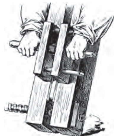
6.14. Pohled na lis s hoblíkem. Na levé straně lisu dobře viditelné vodící lišty. 119
