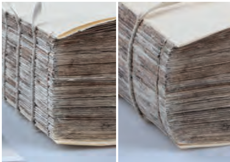
6.9. Detailní pohled na patu bloku po našití bloku a po zaklížení a zaoblení hřbetu. Oblé hřbety složek jsou působením kostky při zatlačování lepidla (klišu) „zarovnány“ (foto – soukromý archiv R. Slovika).
