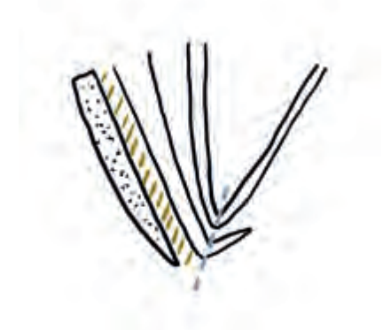
714. Předsádka tvořená dvoulistem obtočeným kolem první a poslední složky. Šití probíhalo prostředkem složky. První list nalepen na předešlý, druhý zůstává volný (sign. XXV.E.α.30). 226
