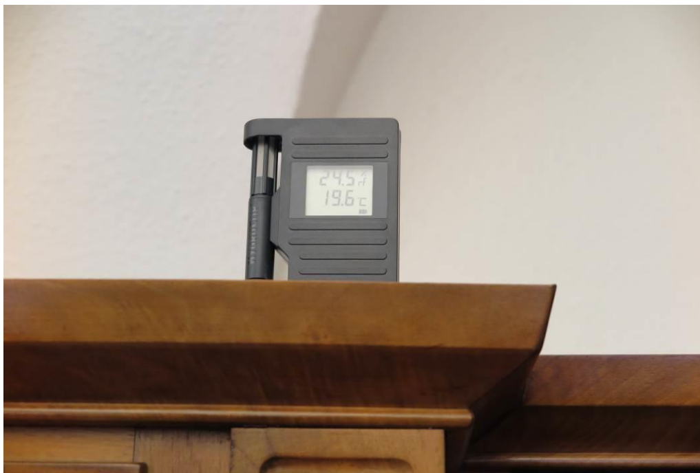
Obr. 23. Klášter St. Gallen, Švýcarsko – průběžné vyhodnocování klimatických podmínek knihovní místnosti kvalitním dataloggerem je v zahraničí samozřejmostí. Foto: Martina Bolom-Kotari (2016).
