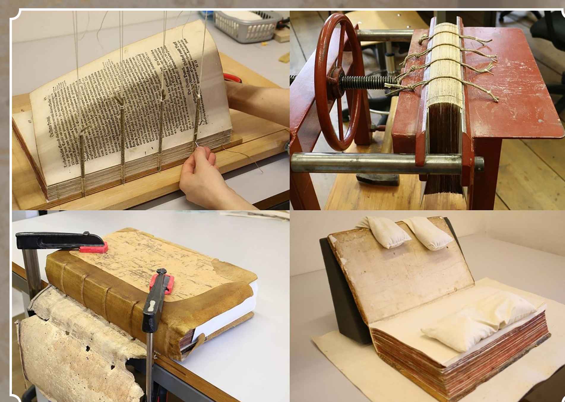
Šití knižního bloku, klizení a kulacení hřbetu, aplikace lokálních usňových záplat, vylepení přídeští, dolažení ztrát papíru papírovou suspenzí.
