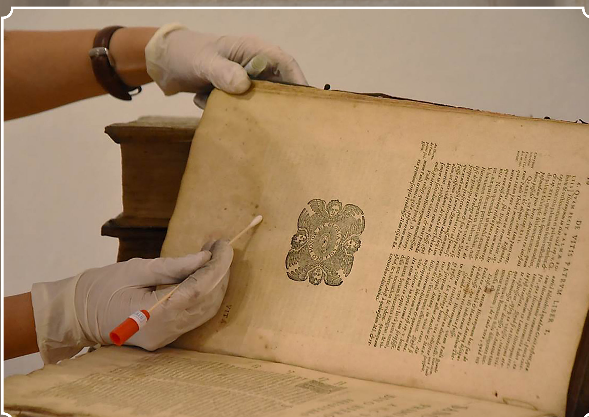
Provedení stěr pro mikrobiologickou analýzu v průběhu průzkumu
